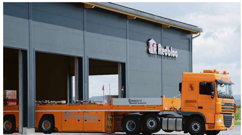
Der Wandtransport: Ein Tieflader bringt die fertigen Redbloc-Wände vom Werk auf die Baustellen. Sogar die Aussparungen für Fenster und Türen oder die Dachschrägen wurden bereits vorgefertigt.
